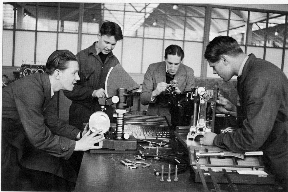
Mätningarna av Pratt & Whitney TW C3 skedde med utgångspunkt från en fabriksny originalmotor.
