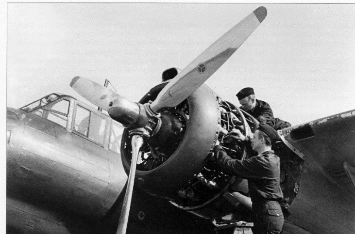
En av de tidigast levererade STW C3 monterades 1943 i en B 18A. Propellern är en licensstillverkad ställbar trebladig Hamilton Hydromatic Hy 31.
