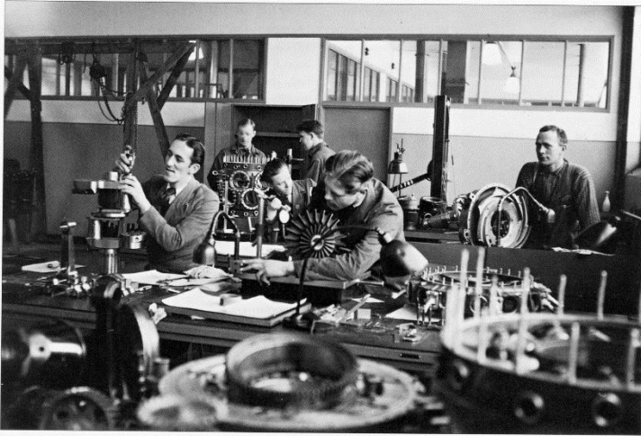
För att skapa ett underlag för korrekta ritningar måste samtliga detaljer i originalmotorer mätas upp med högsta noggrannhet.
